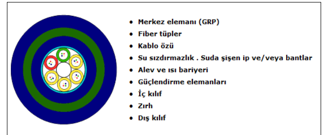
Resim 2: Yangına dayanıklı, zırlı fiber optik kablo kesiti
