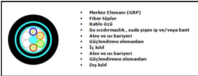
Resim 4: Yangına dayanıklı, zırhsız fiber optik kablo kesiti
