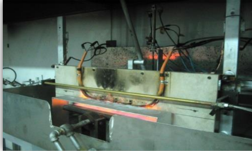
Şekil 4 EN 50200 Test Düzeneği
