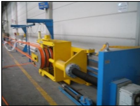
Resim 8: Çekme test düzeneği
