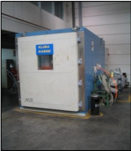
Resim 12: Sıcaklık çevrimi test düzeneği
