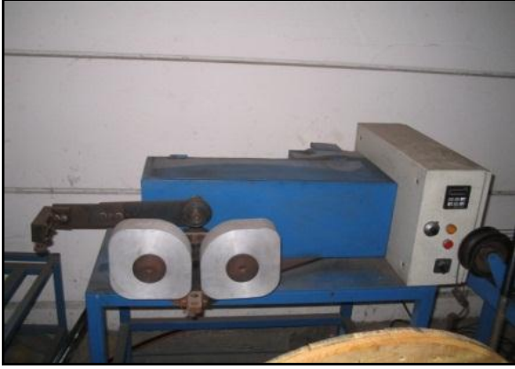
Resim 11: Tekrar edilen bükülme test düzeneği
