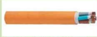
Resim 2: 0,6/1 kV N2XH FE 180 3x35/16 mm² Alçak Gerilim Enerji Kablosu
