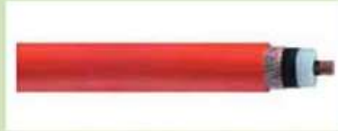
Resim 3: 12/20 kV 1x95/16 mm² Orta Gerilim Enerji Kablosu
