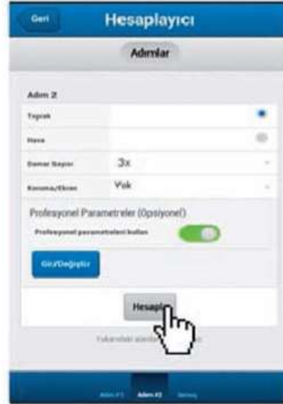
Resim 7: Kablomatik üzerinden kablo tipi ve kesiti belirlemede son adım.
